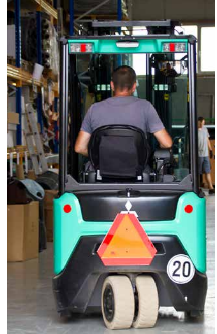
Der EDiA EM 1,8 Tonner ist optimal in engen Gängen. Die Non-Marking Reifen hinterlassen keine Spuren, weder in der Halle noch auf dem gepflasterten Lagerplatz.
