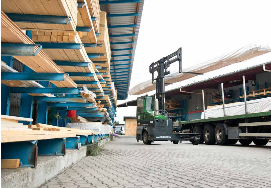
Vom Lkw direkt ins überdachte Außenregal. Der CombiLift C4500 ist optimal für den Transport von langen Lasten und nicht umsonst der meistverkaufte Vierwegestapler der Welt.
